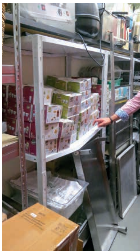
Ein Klassiker: Nicht gesichertes, beschädigtes und überladenes Regal ohne Nutzlastangabe.
