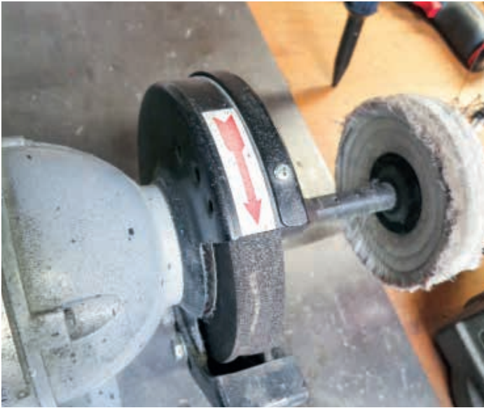
Häufig zu finden: Zu grosse Spalten und fehlende Abdeckungen an Schleifmaschinen.
