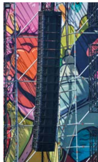
Eine grosse Geschichte: Die beiden Arrays der Main-PA bestanden aus jeweils 16 Panther-Lautsprechern.
