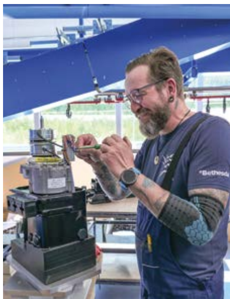
Handarbeit: In der Montagehalle werden unter anderem das Getriebe zusammgebaut und die Schaltung verkabelt.
